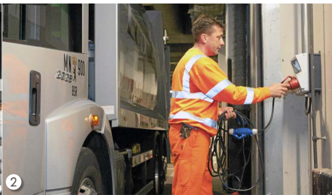
1 An der Kabinenrückwand des Mercedes Econic 2629 6x2/2 sind Hochvolttechnik, Sicherungen und Steuergerät versammelt. 2 Der Müllsammel lässt sich an der 360-Volt-Dose laden.
