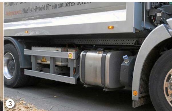
3 Die Akkus finden am Fahrzeugrahmen Platz. Ihr Energiegehalt beträgt 6,9 Kilowattstunden. In drei Stunden lassen sie sich vollständig aufladen.
