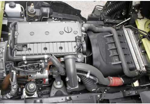
Vier Zylinder und 218 PS: Der OM 924 LA gehört zu den Dauerbrennern im Programm.
