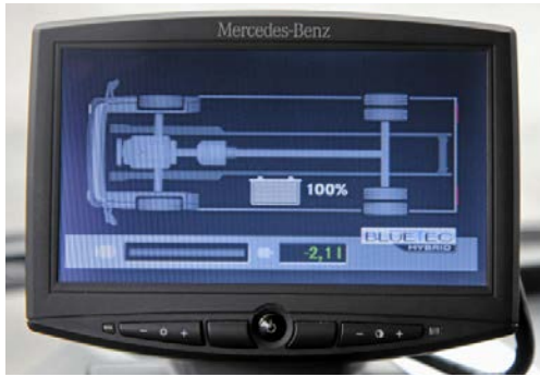
Der Hybrid-Fahrer wird über Zustrom und Verbrauch der elektrischen Energie informiert.
