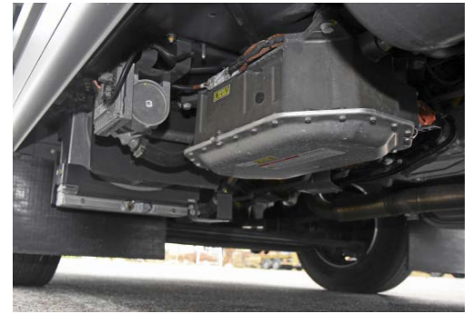
Crashsicher und aufbaufreundlich sitzt der Stromspeicher seitlich am Rahmen.
