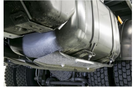
Solide Beplankung für Luftbehälter, Tank und Abgasfabrik gegen Steinschlag und Aufsetzer.
