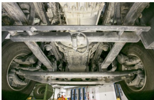
Der höhergelegte Rahmen und die gekröpfte Vorderachse bieten mehr Bodenfreiheit.
