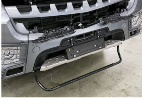
Der ausklappbare Frontbügel bietet sicheren Stand beim Scheibenreinigen.
