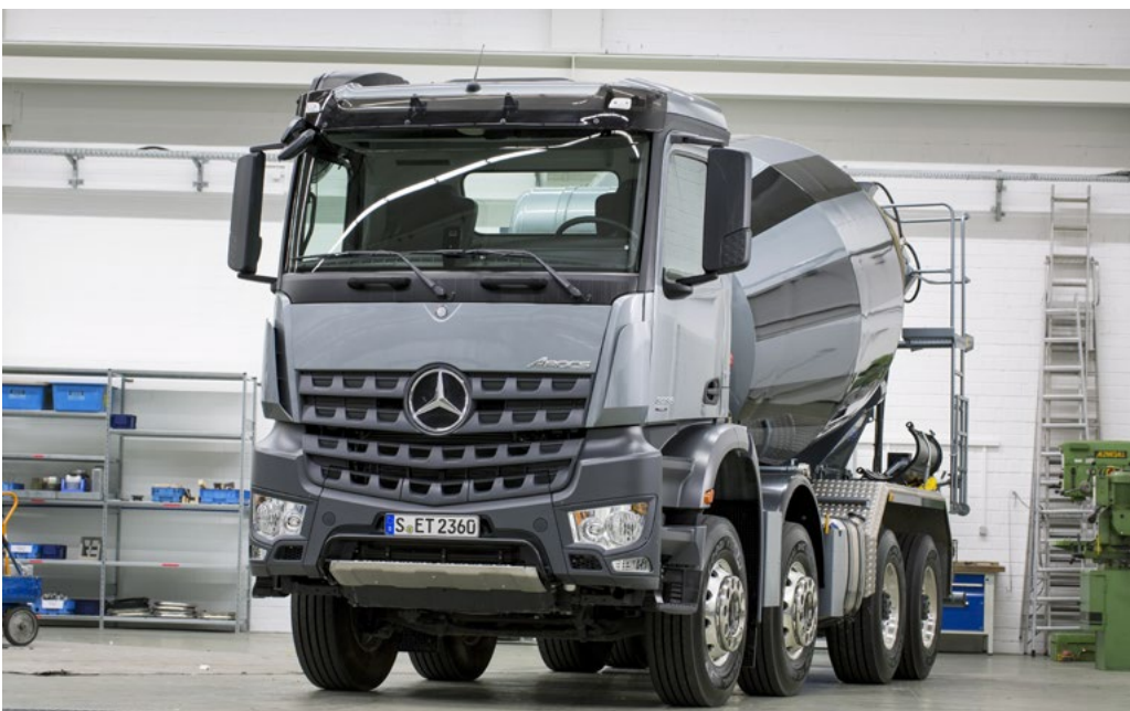
Der gewichtsoptimierte Loader-Betonmischer rollt auf gewichtssparenden Single-Reifen.
