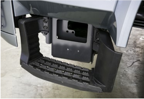
Der griffige Tritt mit flexibler Aufhängung soll jedem Stein standhalten.
