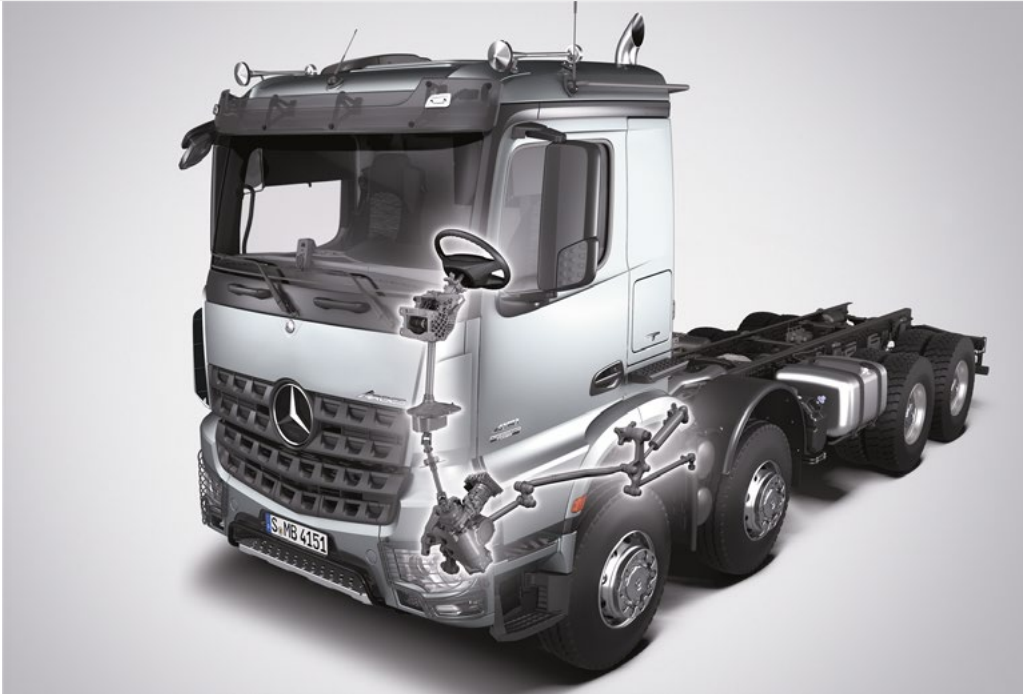
Die elektrohydraulische Zweikreislenkung im Vierachser vermittelt Pkw-ähnlichen Fahrkomfort.
